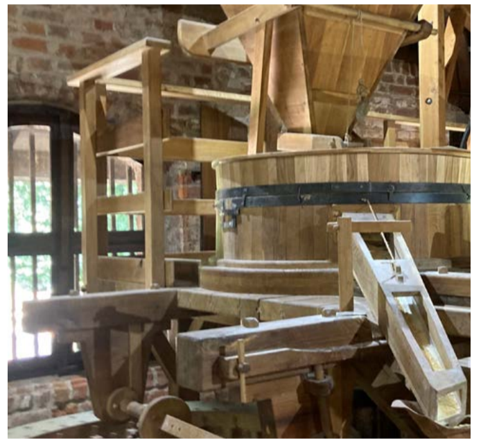
La macchina molatrice, interamente realizzata in legno.
